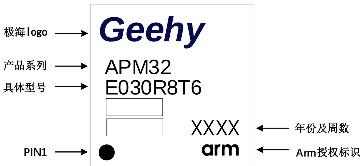
图 22 LQFP64 - 64 引脚, 10 x 10mm 封装标识
