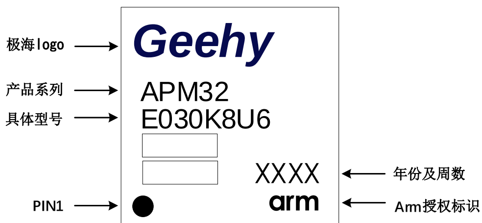
图 34 QFN32 - 32 引脚，5 x 5mm 封装标识
