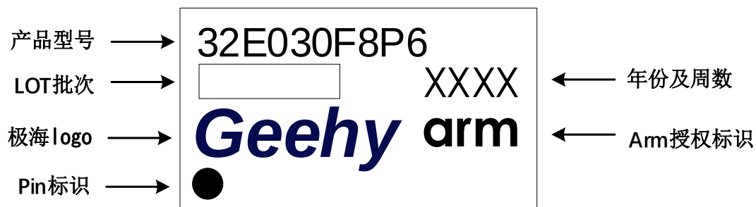
图 40 TSSOP20 – 20 引脚，4.4 x 6.5mm 封装标识
