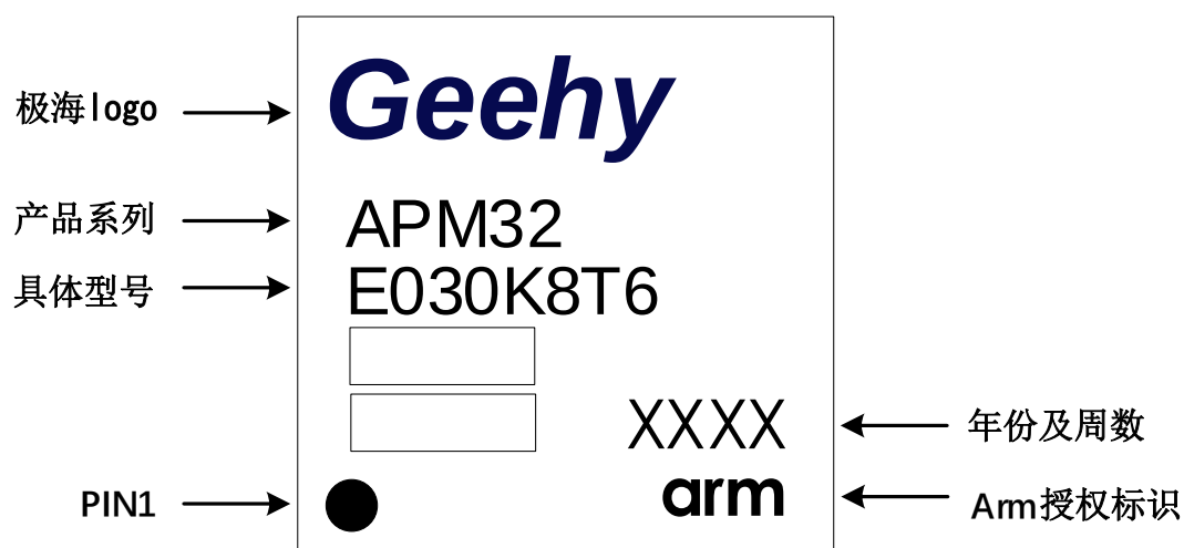
图 31 LQFP32 - 32 引脚，9 x 9mm 封装标识
